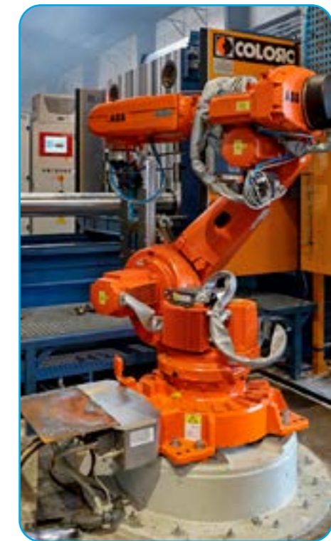
Die Zykluszeit könnte weiter auf 46 Sekunden reduziert werden, jedoch ist der begrenzende Faktor nun der Druckgusszellenroboter.
