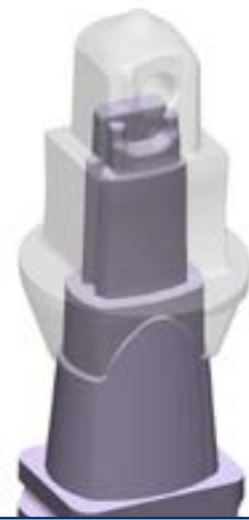
Gegossenes Bauteil VOLLSTÄNDIG FEST ERSTARRT
